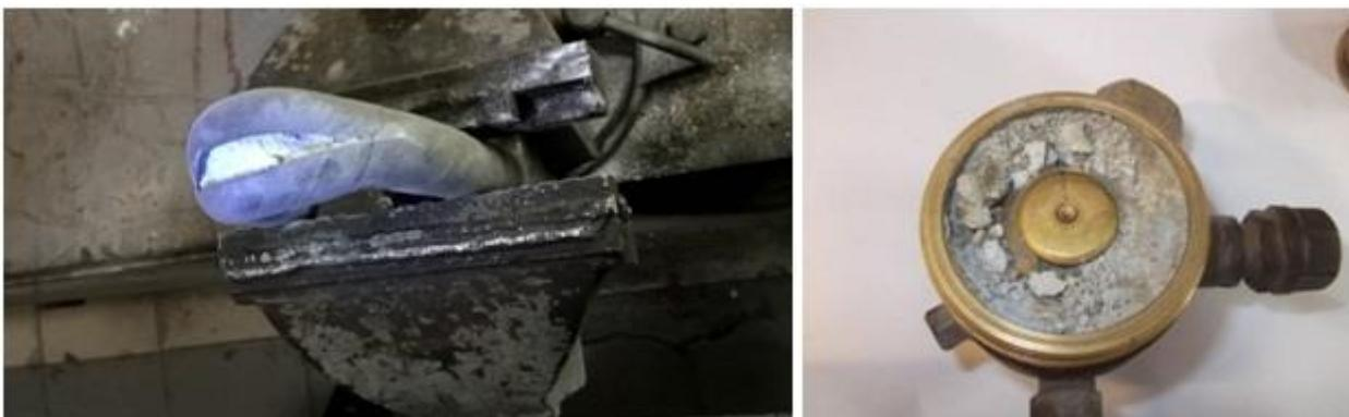
*Внутренние детали растворной линии после воздействия раствора хлористого кальция.*
